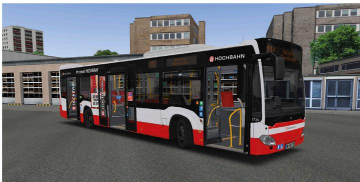
Der Solobus entspricht der 17er-Baureihe der HOCHBAHN und verfügt wie alle neueren Solobusse über 3 Türen, von denen die mittlere als Außenschiebetür ausgeführt ist. Es wurde als Vorbild ein Exemplar mit 4-Gang-Getriebe (Voith) und „Saloon“-Fahrgastschranke an der Vordertür gewählt. Als Ersatz für ältere Fahrzeuge mit Abgasnorm Euro 3 oder Euro 4 wurden bereits über 50 17er ausgeliefert. Dazu kommen noch umgeklebte Fahrzeuge, die ehemals mit Logo der Firma Jasper eingesetzt wurden.
