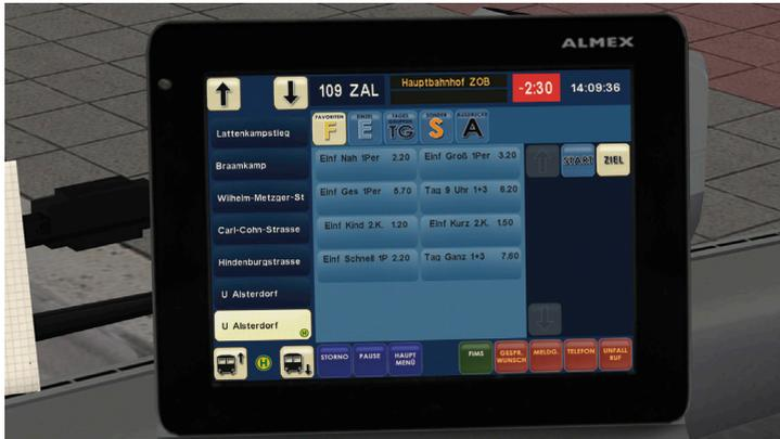
Beim ALMEX-Drucker („EFAD 2“) handelt es sich um einen modernen Touchscreen-Fahrscheindruckers, der auch eine RBL-Schnittstelle zur Steuerung der Haltestellenansagen und Zielanzeige bietet. Der Drucker wurde in Zusammenarbeit mit der HOCHBAHN entwickelt. Aufgrund der Vielzahl der Funktionen sind nur die wichtigsten im OMSI 2 umgesetzt, doch auch das sind eine ganze Menge.
