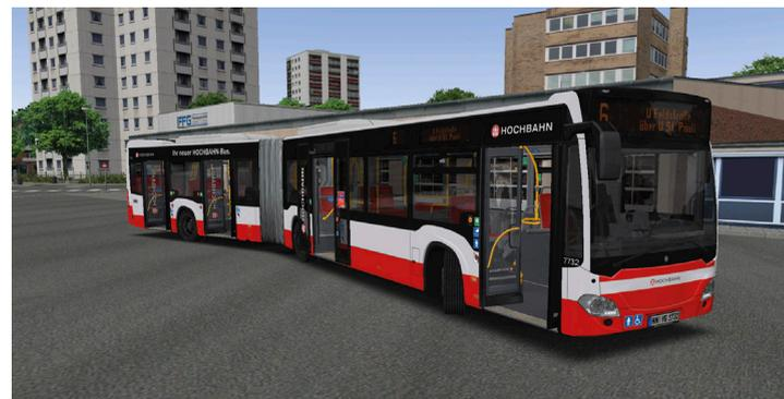
Vom „77er“-Gelenkbus gibt es nur fünf Exemplare, die alle in Hamburg-Harburg stationiert sind. Sie verfügen über vier Türen, davon die zweite als Außenschiebetür. Wie beim Solobus ist die größere Klimaanlage installiert. Ausgewählt wurde hier ein Vorbildfahrzeug mit 6-Gang-Automatik (ZF).
