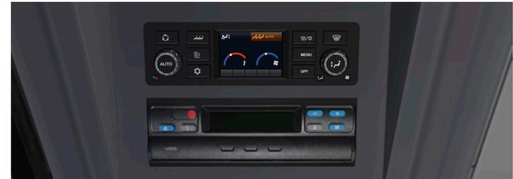
In den Sägezähnen über dem Fahrerplatz finden Sie das Klimabedienteil (siehe Heizung und Klimatisierung) und den Modulartachografen (ohne Funktion).
